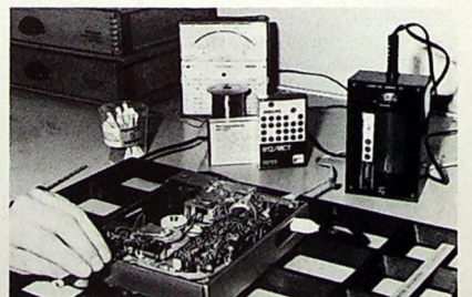
Bild 4. Einstellung der Bandgeschwindigkeit
